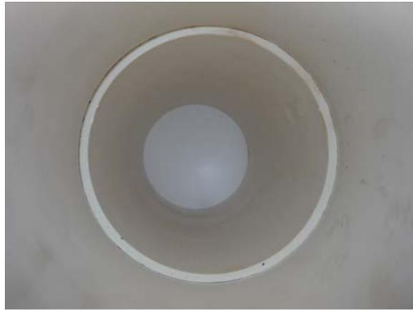
Vista interior da ligação completa, topo a topo, entre dois segmentos de tubagens em PVC com ligações roscadas, observando-se ligeiro ressalto na zona da união.
