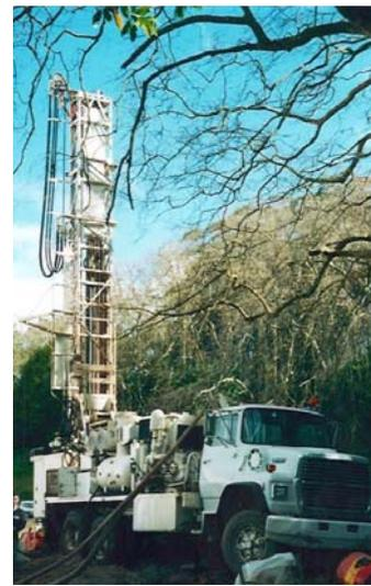
Sondas de perfuração montadas em camião de vários eixos.
