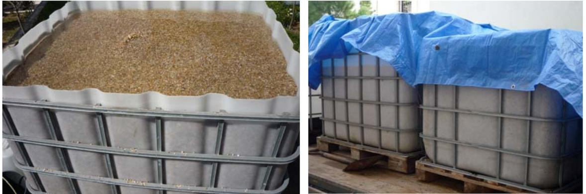
Contentores de transporte de areão silicioso, calibrado e lavado, emerso em solução desinfectante.
