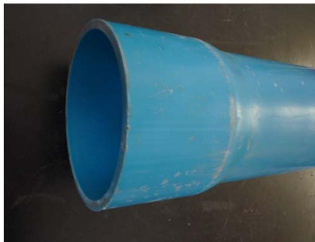
Exemplo de tubagem em PVC, abocardada, sem ligação roscada no topo, não recomendável como tubagem de revestimento definitivo, em furos de água mineral.
