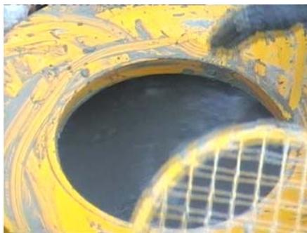
Mistura da água e do cimento na cuba de alta rotação.
