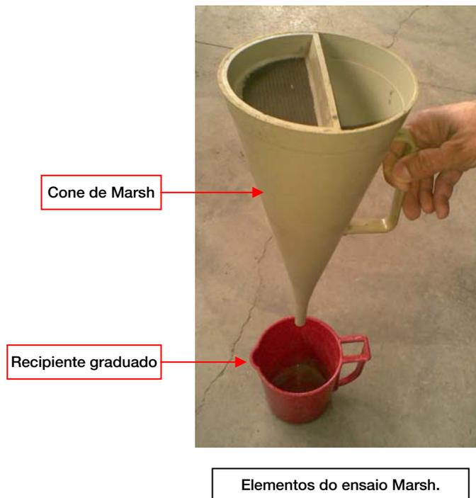
A viscosidade das lamas deverá ser a menor possível, e apenas a suficiente para permitir uma adequada limpeza dos resíduos de furação e manter as paredes do furo estáveis, com a formação de um fino filme gelatinoso nas suas superfícies.
