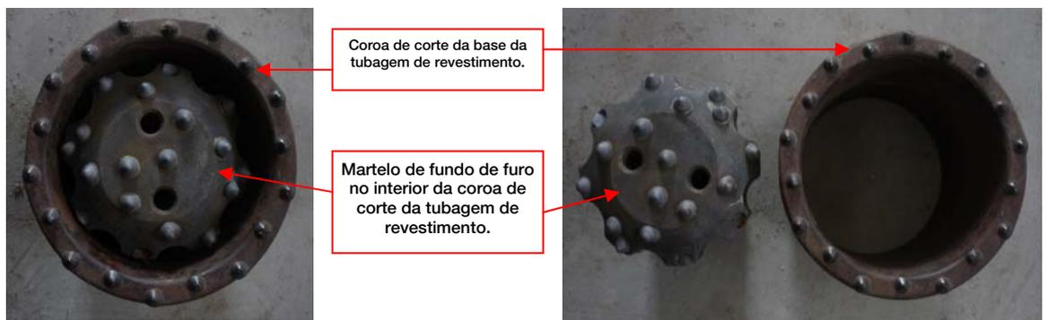
Sistema de rotopercussão com entubamento simultâneo - Ferramentas de corte do método Elemex RotoOdex
