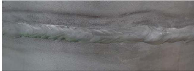
Exemplo de excerto de um cordão de soldadura entre segmentos de tubagem.
