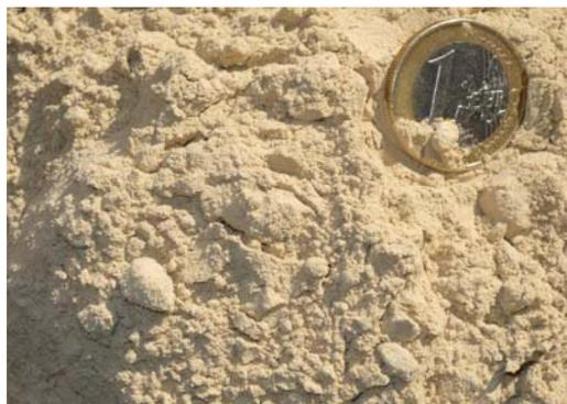
Argila expansiva em pó, bentonite, utilizada na elaboração de lamas de estabilização
