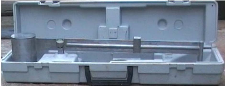
Balança para determinação da densidade da calda de cimento
