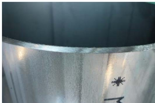
Superfície regular do topo de um segmento de tubagem de revestimento definitivo em aço inox.
