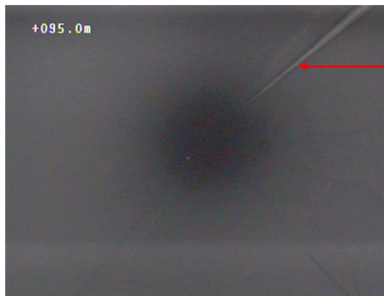
Costur ou soldadura longitudinal da tubagem de revestimento.
