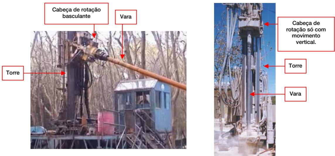
Cabeças de rotação, fixa e basculante.
