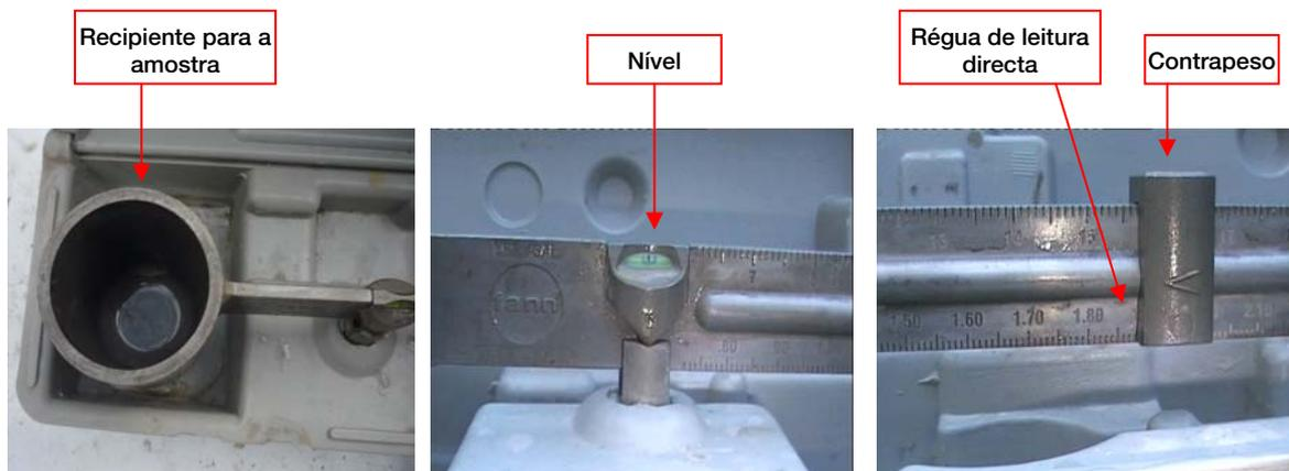
Balanca para determinação da densidade das lamaz de estabilização.
