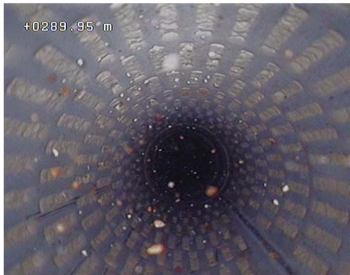
Fotografia de endoscopia – tubo ralo com rasgos em ponte, totalmente colmatado, com restos de lamas de estabilização. Vista axial.
