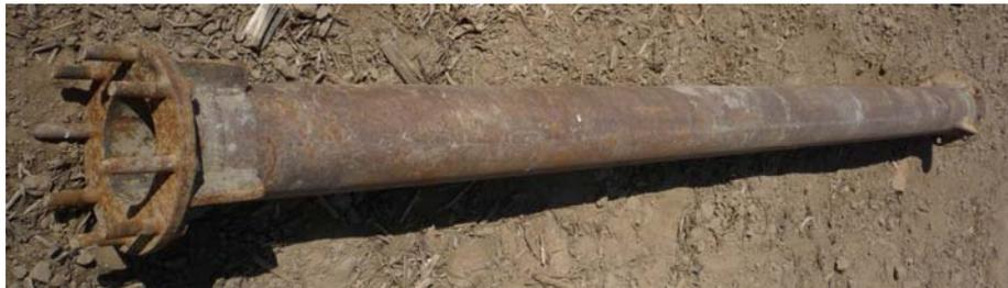
Vara de circulação inversa simples utilizada com bomba centrífuga.
