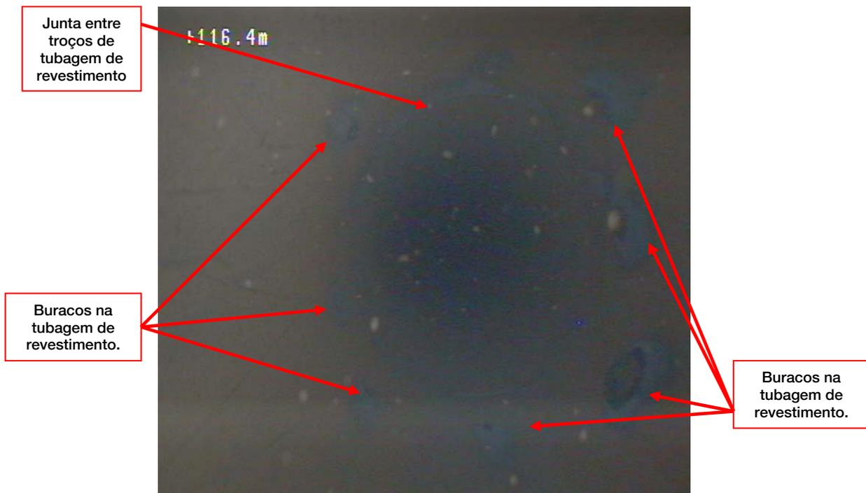
Fotografia de endoscopia – Diversos buracos na tubagem de revestimento, resultantes da oxidação de rebites aplicados localmente. Observava-se um importante fluxo de entrada de água através destes buracos, originando grande turbulência das partículas em suspensão na água. Este sector de tubo fechado deveria impedir a entrada de águas destes níveis aquíferos. Vista axial.
