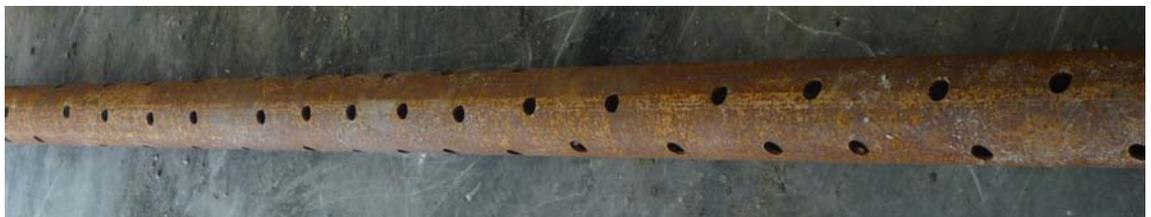
Tubagem perfurada, que é colocada na base do trem de varas, para injeção lateral de ar comprimido directo.
