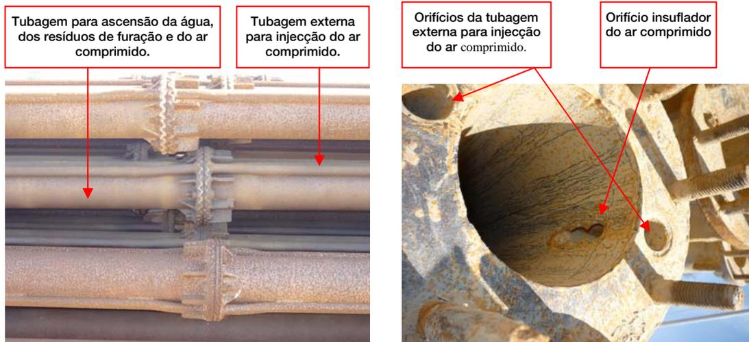
Varas de circulação inversa com tubagem exterior para injeção do ar comprimido.
