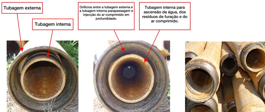
Varas de circulação inversa com parede dupla para inieção do ar comprimido.
