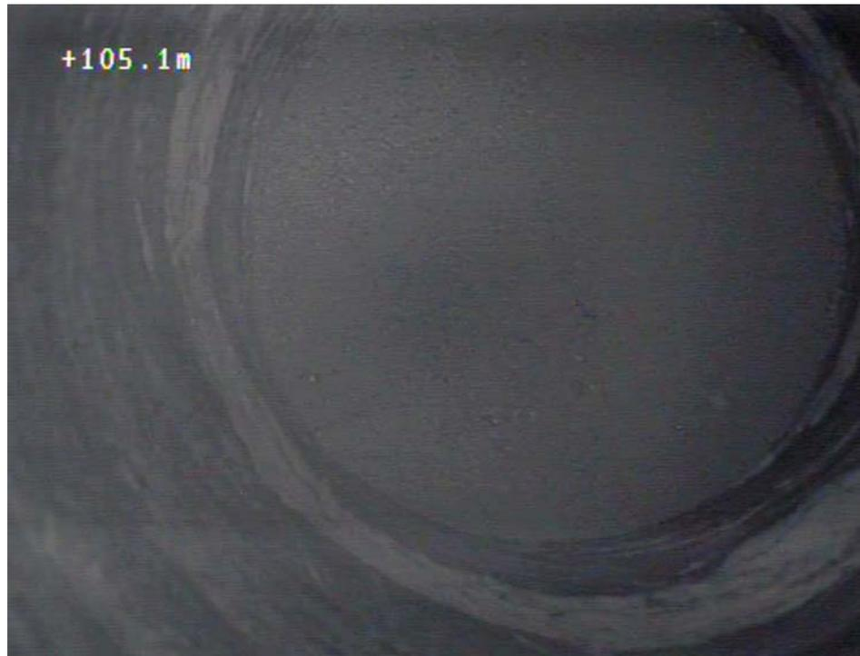
Fotografia de endoscopia – Sector da base de um furo em “open hole”, ou sem revestimento. Vista axial.
