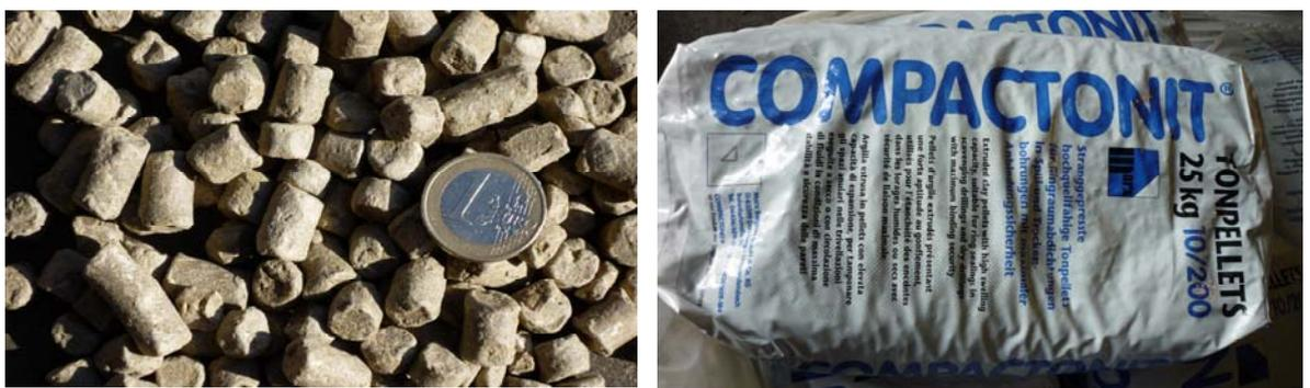
Granulado de argila expansiva para isolamento.
