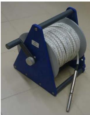
SONDA DE MEDIÇÃO DO NÍVEL DA ÁGUA NO FURO
