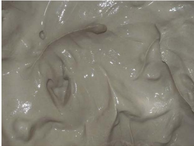
Gel obtido através da mistura da argila expansiva com água.
