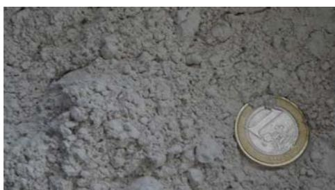
As caldas constituídas apenas por argilas bentoníticas em pó, a que é adicionada água, correspondem a um fluído com elevada densidade, sem coesão e com um alto teor em água, não apresentando qualquer função resistente. Estas caldas mantêm-se viscosas, como um gel, enquanto estão em contacto com a água. Se secarem em contacto com o ar originam-se fendas de retracção.
