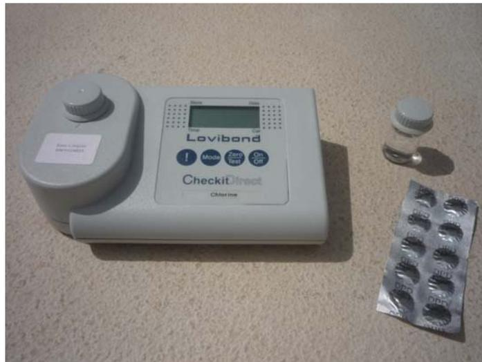
Fotómetro portátil para determinação do cloro residual.
