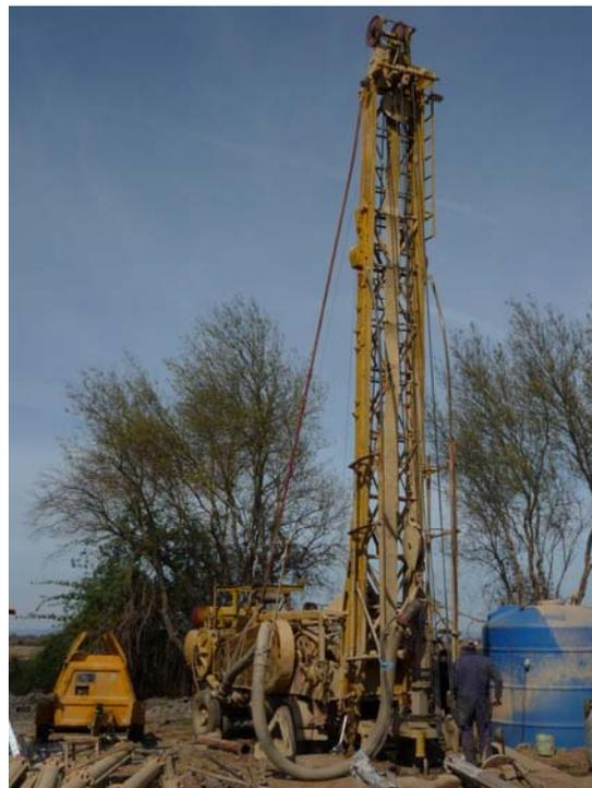
Sonda de perfuração montada em atrelado.
