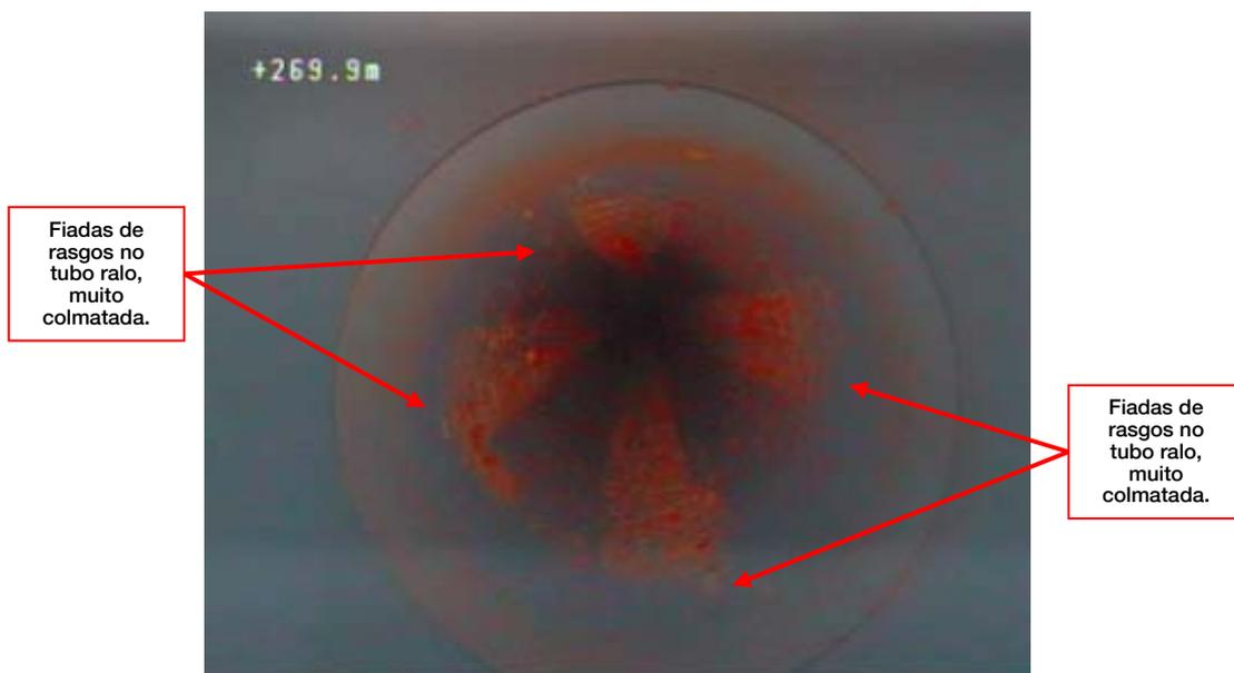
Fotografia de endoscopia – tubo ralo com quatro fiadas de rasgos intensamente colmatados. Vista axial.
