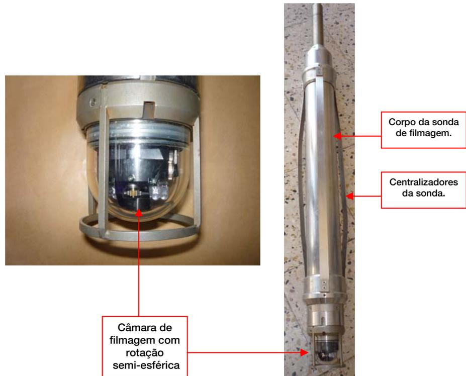
Sonda de endoscopia com uma câmara de filmagem com rotação semi-esférica.
