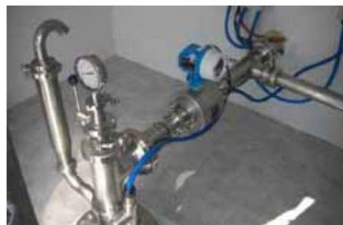
Exemplo de cabeça de captação projectada de modo a evitar contaminações e permitir amostragens
