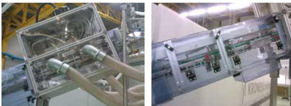
Exemplo de equipamento para filtrar ar e cobertura de um tapete transportador
